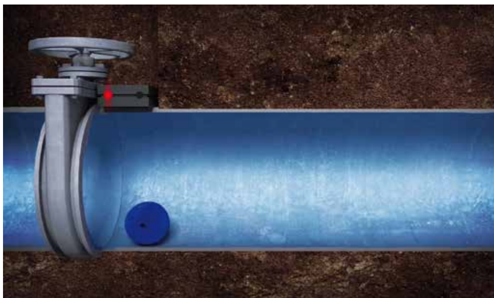
SmartBall, la sfera "intelligente" che scorrendo nella tubazione rileva con precisione metrica le perdite e la posizione della condotta
